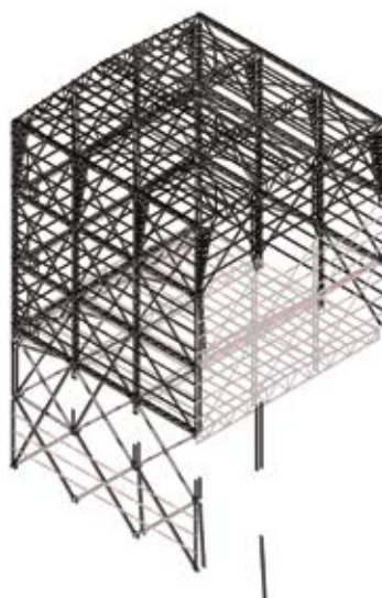
Ampliación nave Lorca , gran nivel de detalle de estructuras metálicas con uniones atornilladas con geometrías complejas, unido al hecho de ser un proyecto de ampliación de un edificio existente, con una información de partida confusa que había que modelar también. Sin BIM habría sido un planteamiento totalmente distinto, puesto que es inviable resolver bidimensionalmente ese tipo de uniones. El uso de las fases, para poder distinguir zonas existentes, demolidas y nuevas, fue también fundamental.
