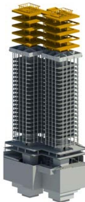
Rascacielos emblemáticos de Madrid, 1967. La obra destaca por su estructura suspendida o colgante, diseño innovador en su momento. La remodelación, a cargo de Luis Vidal + arquitectos, mantendrá esa estructura original de Antonio Lamela, modificando la arquitectura exterior para adaptarla a las necesidades actuales.
